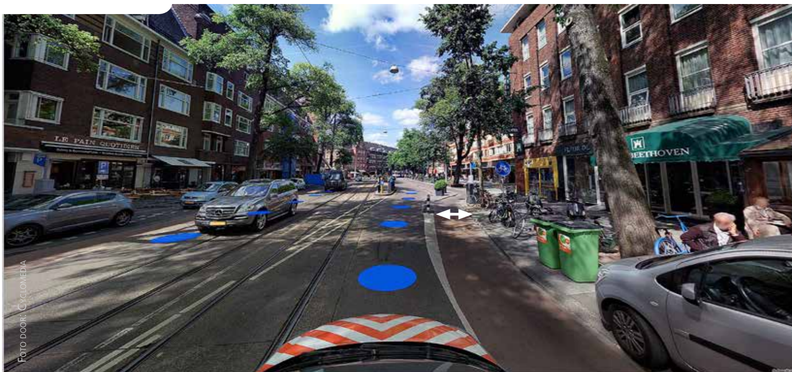
Dit wegvak in Amsterdam is in kaart gebracht met de CycleRAP-methode. Er is een wegvak van 25 meter beoordeeld, de beoordelaar kan de lengte aflezen van de blauwe stippen, die iedere 5 meter staan. Zie ook tabel
