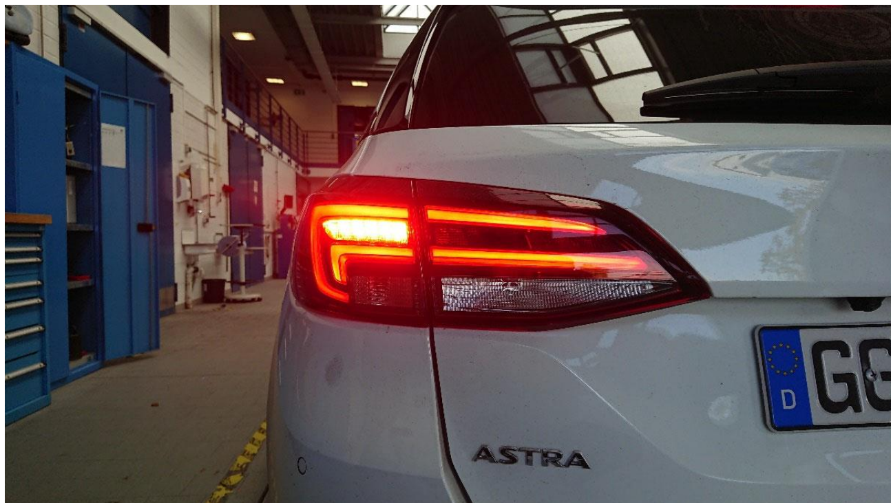
LED achterlichten en remlicht van een Opel Astra Sports Tourer mj 2019, kans op verblinding door fel licht en klein uitstraal oppervlak
