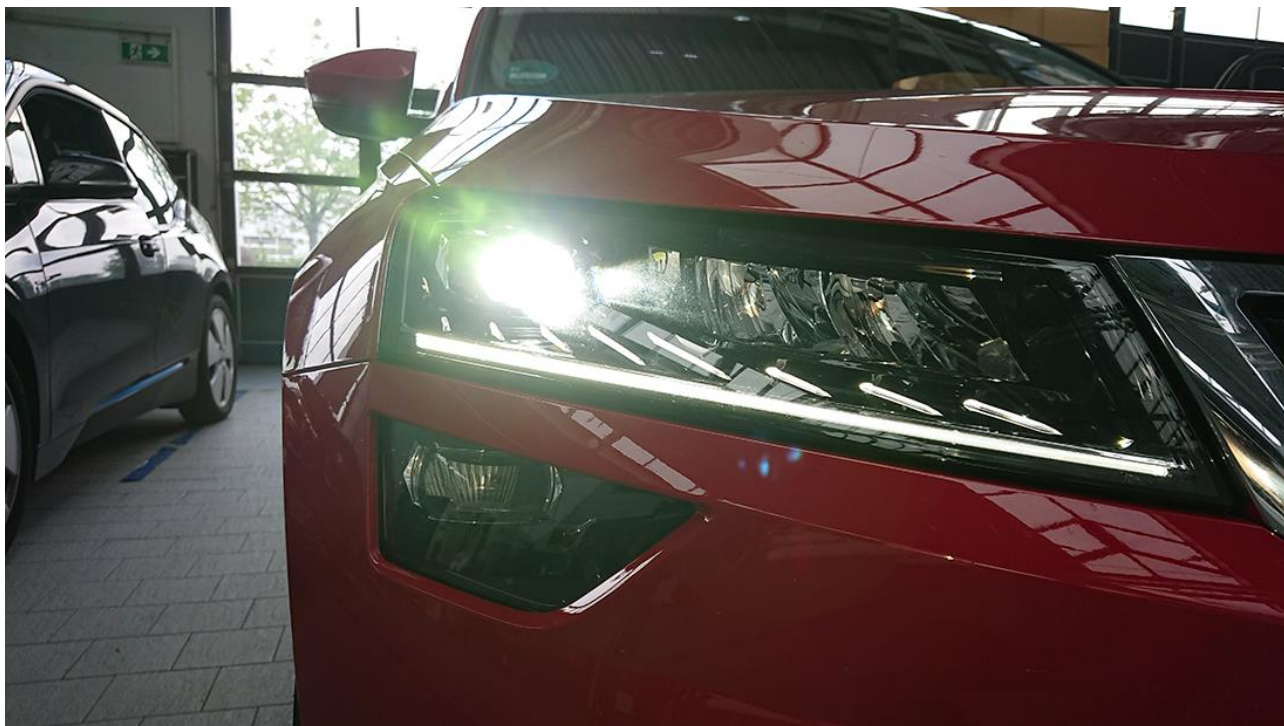
LED-koplamp met lens projectie systeem, hier ingeschakeld dimlicht van een Skoda Karoq mj 2019, steeds kleinere lampen zijn mogelijk.
