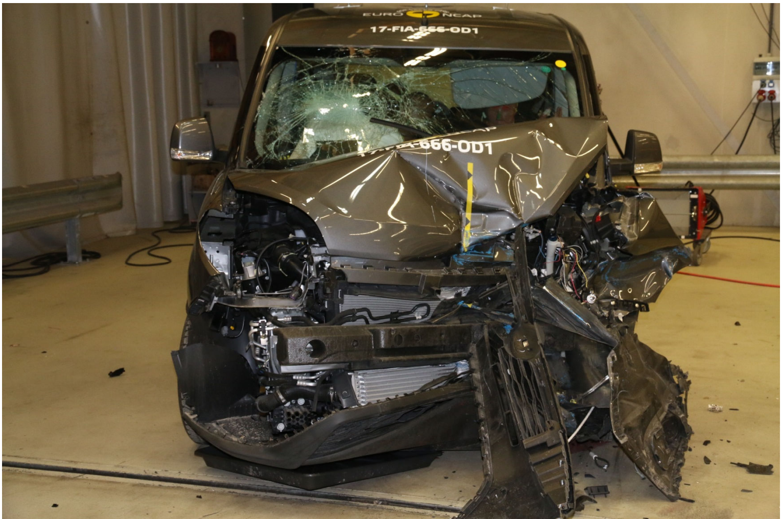
Zo ziet de Fiat Doblò er na de crashtest uit, in dit geval na test 1, de frontale offset test.
