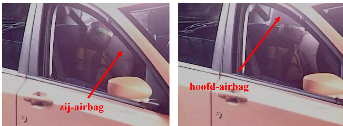
Zitverhoger zonder rugleuning in een zijdelingse botsing met een auto met zij- en hoofdairbag
